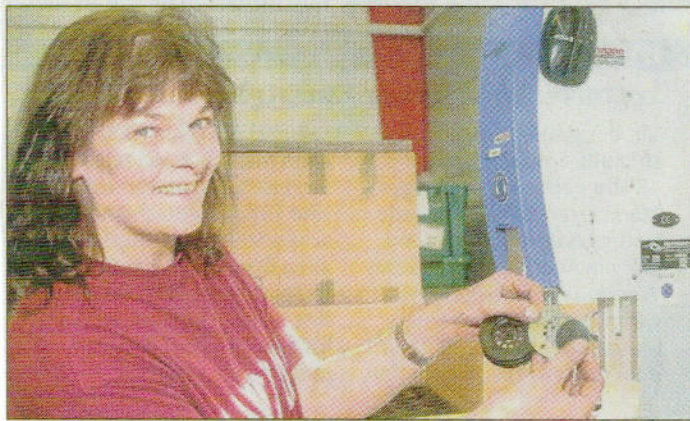
Ultraschallschweißen: Mitarbeiterin Edith Trusheim setzt eine Membran für den Ford Fiesta zusammen.
